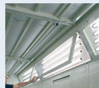
Hinged light fixtures for ease of cleaning and maintenance. Plafoneras en ángulo con bisagras para la limpieza y la manutención.
