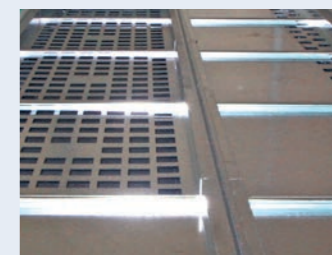
Paint-stop filter trays for air evenness in the booth box. Bandejas selectoras del flujo de aire en el basamento.
